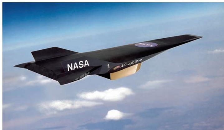
— Экспериментальный гиперзвуковой аппарат NASA X-43A, разогнавшийся собственным двигателем до  $M=9,6$ . Фото:
