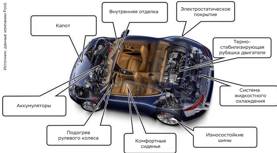
— Схема применимости графена в девяти узлах легкового автомобиля
