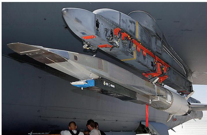
Гиперзвуковая крылатая ракета X-51A Waverider, закрепленная на пилоне самолета-носителя B-52 перед летными испытаниями.
